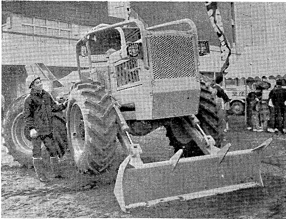
集運材用に使用される車輪式トラクター 谷合いの傾斜地 泥ぬい地でも楽に運材する タイヤの直径1.5倍でタイヤ一本で30万円もする
