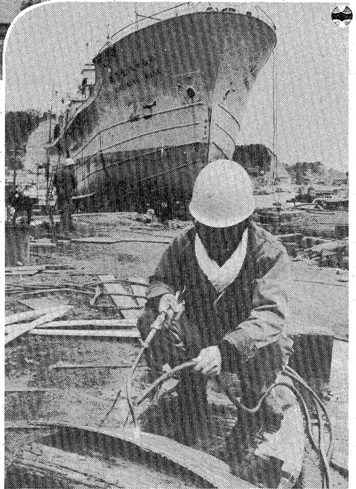
▲アセチレンガスの炎と水を使い、膨張と収縮の原理を応用して複雑なカーブのトモ板を作る
